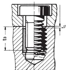
Avant de tarauder, assurez-vous qu'il y a un chanfrein à 90° et qu'il n'y a pas de bavures. Diamètre extérieur du **chanfrein = D<sub>HC</sub> + 0.1 mm**.
