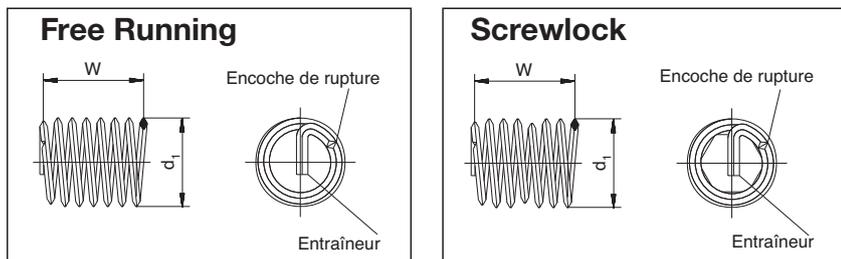
Les cotes de contrôle des filets rapportés avant montage sont W et d<sub>1</sub>.
